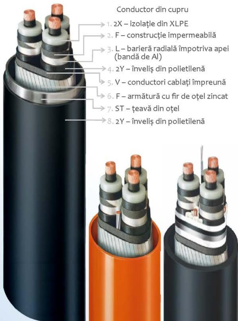
Avantajele cablurilor în țeavă și avantajele cablurilor cu izolație XLPE sunt combinate. Acest cablu a fost proiectat special pentru utilizarea în rețele urbane la rețehnologizare sau pentru instalații noi. Multe dintre elementele de design existente l-au făcut să fie luat în considerare pentru instalarea în țevile deja existente. Această procedură facilitează reconstrucția mai economică a circuitelor de țevi mai vechi și instalarea acestora în zone urbane aglomerate.
